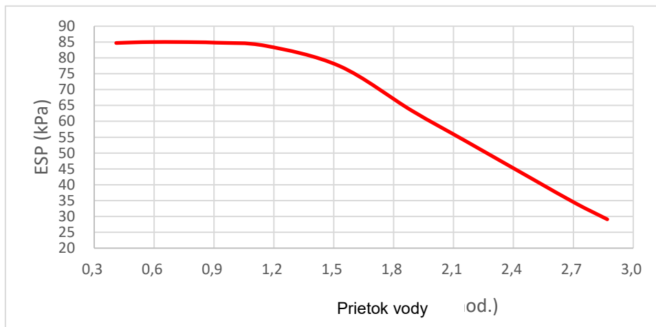
Obrázok 2-6.1: MHC-V4(6, 8, 10)W/D2N8-B hydronický výkon 1
